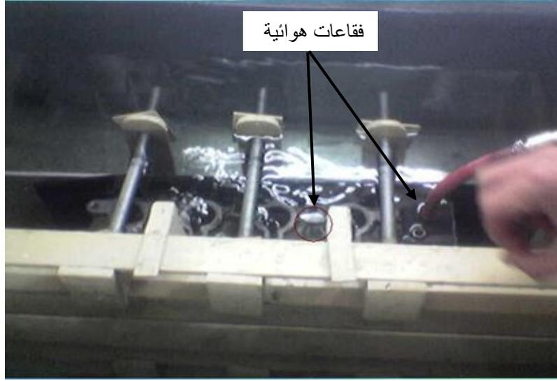
شكل رقم (4): اختبار رأس الاسطوانة على آلة الاختبار بالضغط
