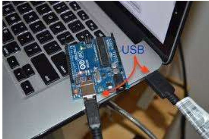
الشكل 7: توصيل لوحة الأردوينو مع الكمبيوتر
