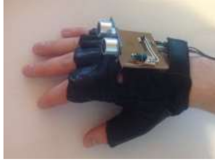
شكل 2: القفاز الذكي يستخدم لتببيه الشخص المكفوف عن طريق اهتزازات مختلفة [4].
